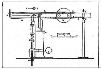
FIG. 14. - SINGLE-LEVER TESTING MACHINE
