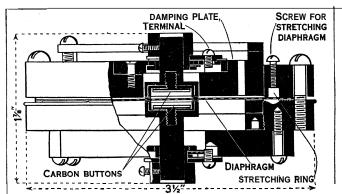
FIG. 1.— WESTERN ELECTRIC DOUBLE-BUTTON CARBON MICROPHONE
