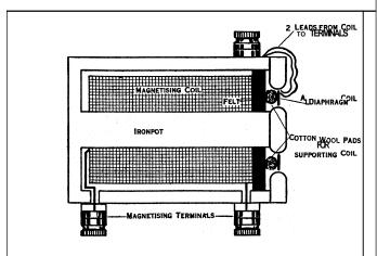
FIG. 4.—SYKES-ROUND ELECTRO-DYNAMIC MICROPHONE
